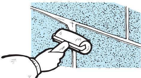
ユーネックスシートに、浮きが生じている場合は、硬質ゴム製ローラーで圧着してください。
